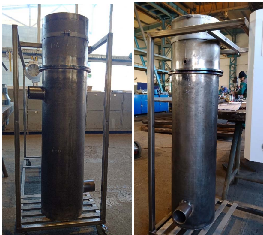
Fig. 16 Stand mobil pentru testarea recuperatoarelor de căldură produse
